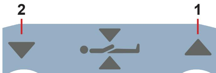
Abb. Pedale zur Einstellung der Betthöhe (Fußschalter zur Höheneinstellung)
